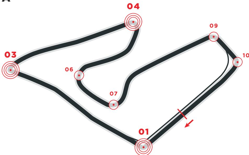
Il circuito di Spielberg è un tracciato molto ondulato, caratterizzato da curve secche con 7 frenate con decelerazioni importanti. Il circuito è inoltre abbastanza corto e tra una frenata e l'altra c'è poco spazio per raffreddare l'impianto.
