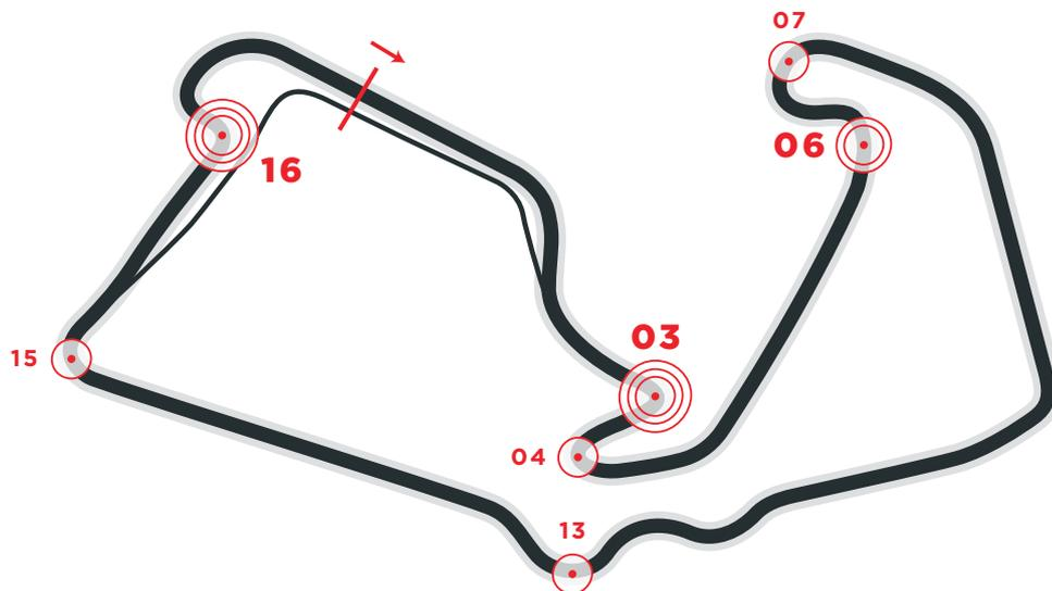
È il tracciato forse meno impegnativo per l'impianto frenante con appena il 15% del tempo sul giro speso in frenata. Si tratta, infatti, di un circuito molto "guidato" dove i curvoni veloci determinano generalmente frenate poco impegnative.
